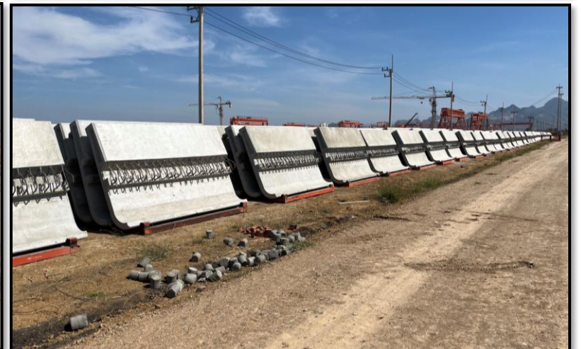
งานหล่อ Precast Parapet ที่โรงหล่อสระบุรี
