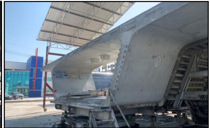
งานผลิตชิ้นงาน Box Segment ที่โรงหล่อ GEL
