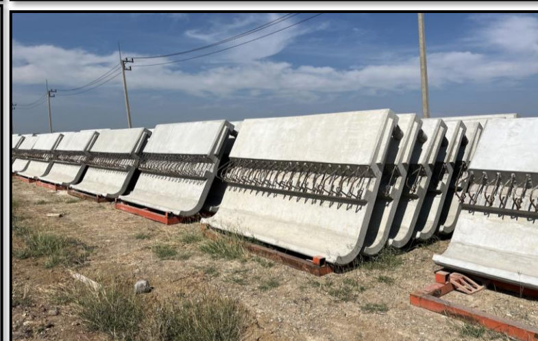
งานหล่อ Precast Parapet ที่โรงหล่อสระบุรี
