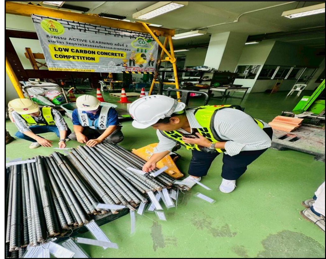
วันที่ 25/06/2568 Inspection & Testing Reinforcement Steel Bars (Control Test) Zone 3 At มจพ. (พระนครเหนือ)
