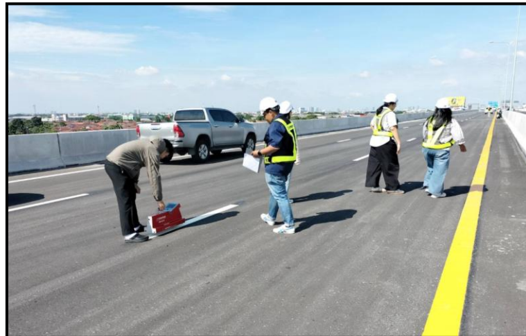
งานทดสอบค่าสะท้อนแสงสี Road Marking ตามมาตรฐาน MLP01-01 to MLP02-21
