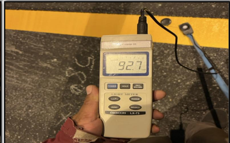
งานตรวจสอบวัดความเข้มของแสงสว่างบนถนน MLP01-01 to MLP02-21
