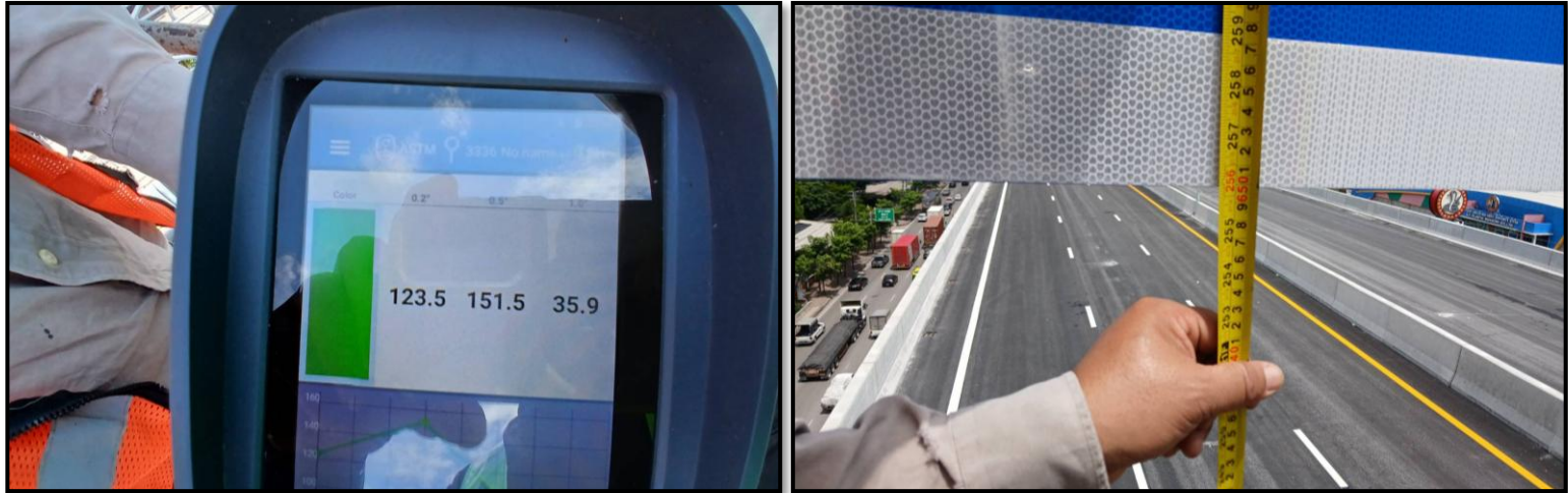
งานทดสอบค่าสะท้อนแสง Traffic Sign MLP01-25 to MLP02-19
