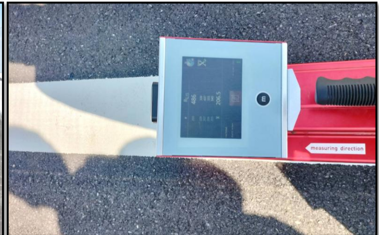
งานทดสอบค่าสะท้อนแสงสี Road Marking ตามมาตรฐาน MLP01-01 to MLP02-21
