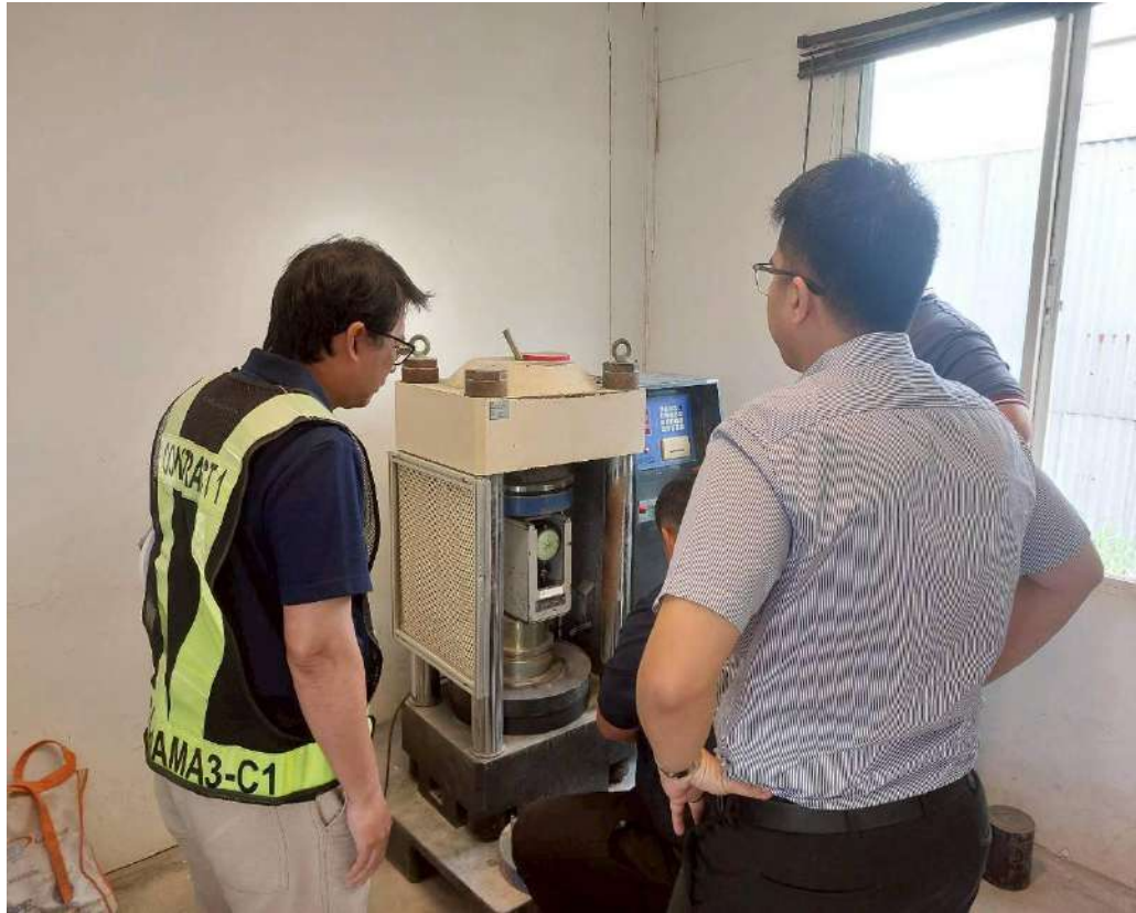
วันที่ 30/10/2568 Inspection Calibration Compression Machine M concrete Test By KMUTT
