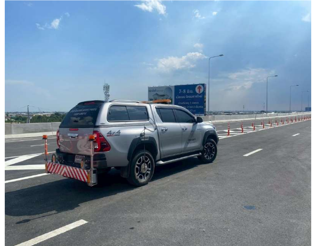
วันที่ 16/10/2568 ทดสอบหาคความขรุขระ Asphaltic Concrete โดย สำนักวิเคราะห์และตรวจสอบ กรมทางหลวง
