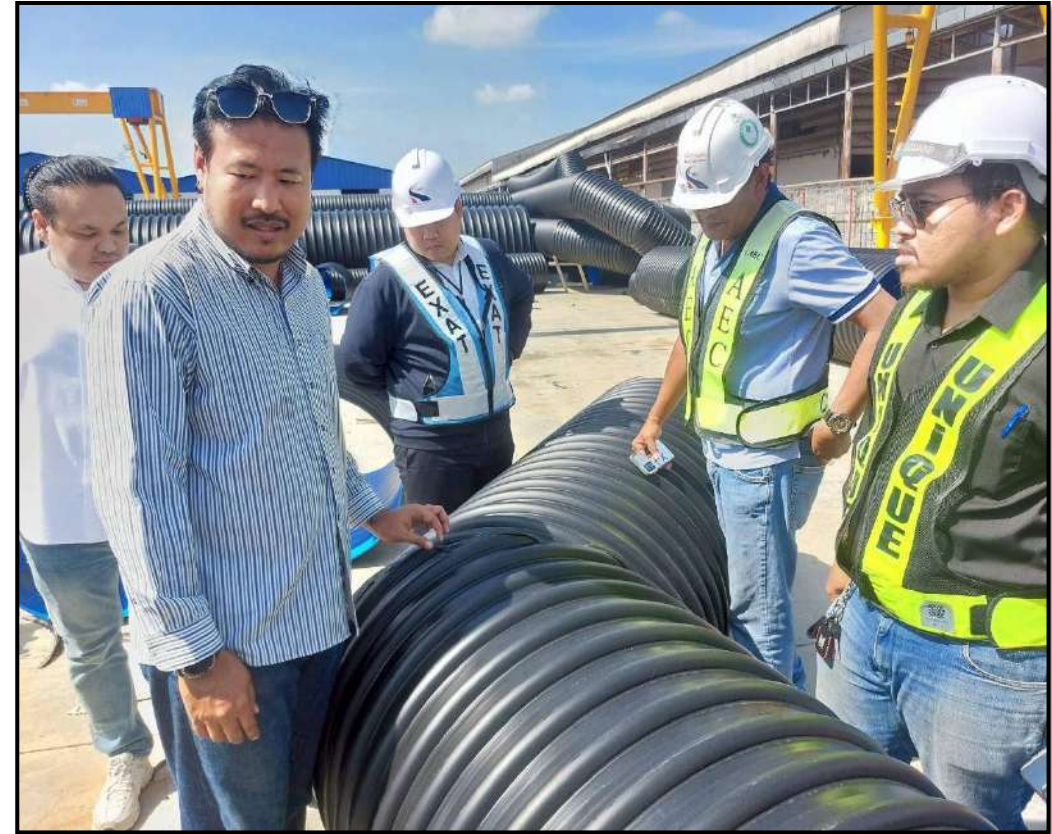
วันที่ 11/11/2568 Inspection & Testing ท่อลอนพอลิเอทิลีนเสริมเหล็ก (Steel Reinforced Polyethylene Corrugated Pipe) ที่โรงงาน V RUS Corporation จ.ปทุมธานี
