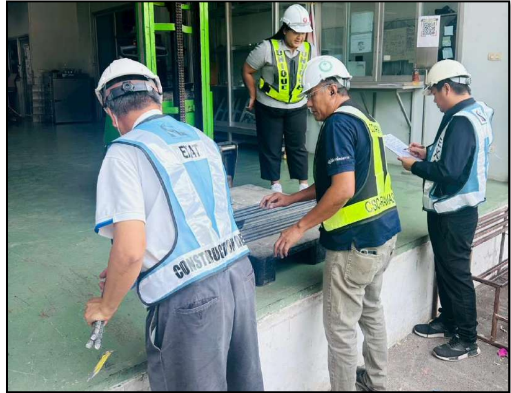
วันที่ 05/03/2569 Inspection & Testing Reinforcement Steel Bars (Control Test) Zone 1,2 Test By KMUTNB.
